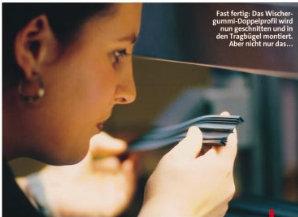
...jedes hundertste Wischblatt wird auf dem Prüfstand getestet, muß das Wasser absolut streifenfrei von der Scheibe ziehen
