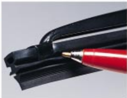
Bosch Twin mit innenliegender Feder – hier wird die Kralle zum Zerlegen leicht aufgebogen
