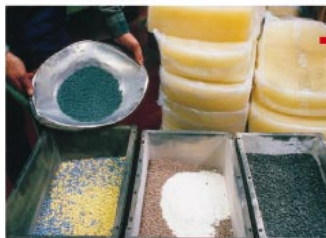
Die Mischung macht's: Zum Rohgummi kommen Ruß für die Farbe und verschiedene Chemikalien gegen Alterung oder für bessere Verarbeitbarkeit
