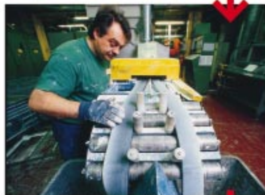
Fertig gemixt: Am Ende entläßt die Maschine schmale, endlose Gummibahnen zur Weiterverarbeitung
