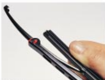
Beim Zusammenbau darauf achten, daß der Gummi wirklich durch alle Krallen geführt wird
