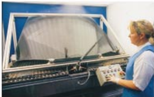
...jedes hundertste Wischblatt wird auf dem Prüfstand getestet, muß das Wasser absolut streifenfrei von der Scheibe ziehen
