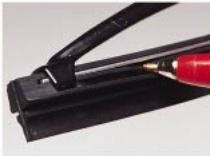
Herkömmliches Wischblatt: Nicht biegen, den Gummi einfach nach links aus der Kralle herausziehen
