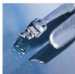
Übel Ablageverformung: Die Wischlippe bleibt nach dem Abschalten so gekippt liegen
