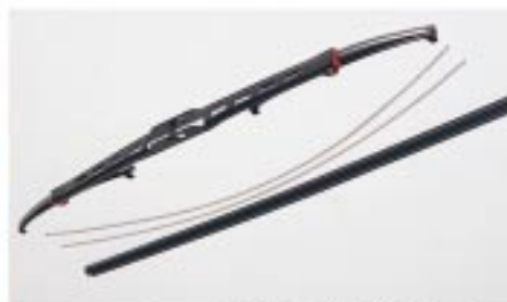
Bausatz: Unbedingt die Lage der Federn merken. Die Wölbung muß immer Richtung Gummi liegen
