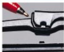
Billigste Lösung: Trag- und Gelenkbügel mit Blechlaschen geklemmt
