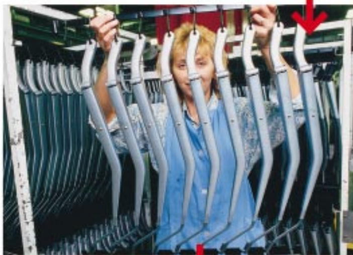
Währenddessen: Parallel zur Gummierstellung werden bei Bosch auch Wischerarme montiert und lackiert
